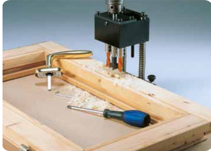
Foratura di finestra in legno e PVC per inserire la scatola cremonese Drilling of wood and PVC window frames to fit cremone bolts
