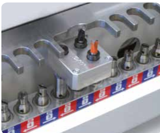
Maschera di foratura a interasse 32 Drilling jig for multi spindles machines 32 mm
